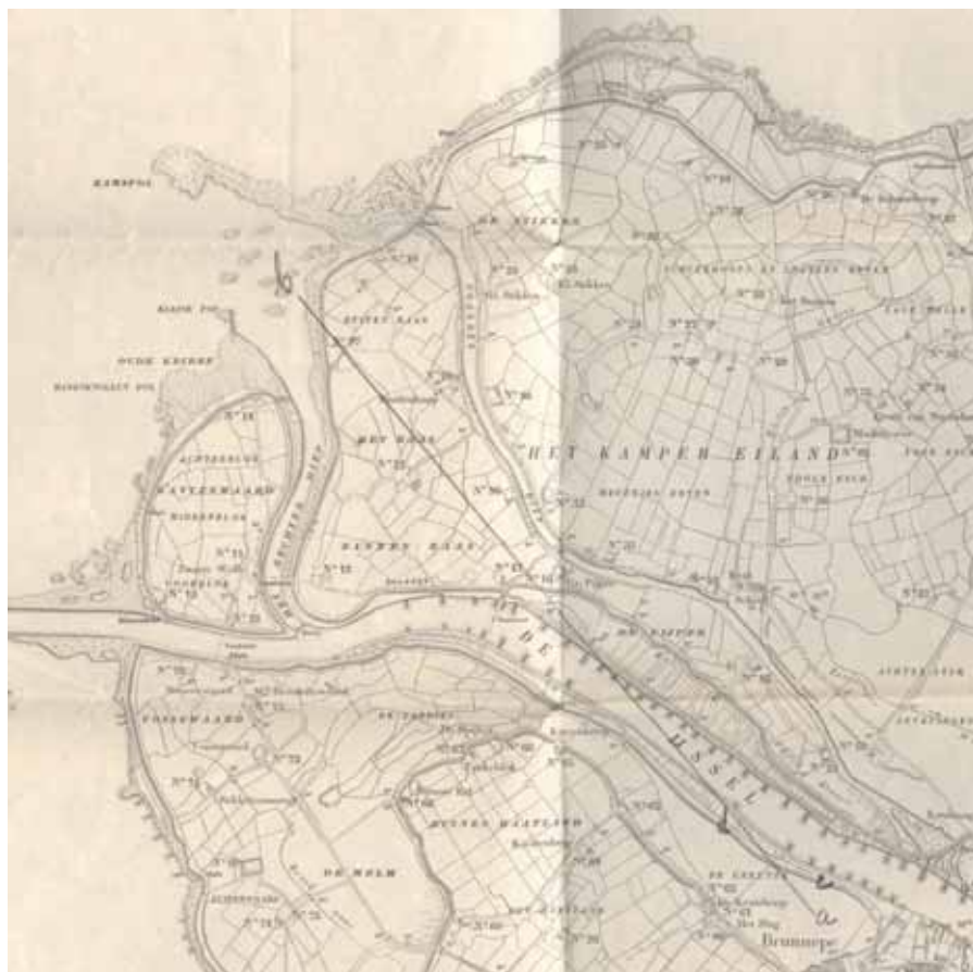
Plan voor de aanleg van een schietbaan op de Greente. Bij a de vier schietpunten, de lijn a-b is de schietsrichting en ter hoogte van de n van Greente is haaks op de schietsrichting de kogelvanger gepland. (Collectie Gemeentearchief Kampen)
