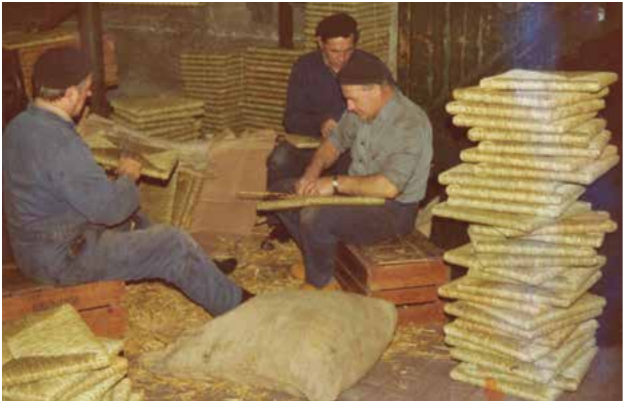
Jannes Last (geheel links) is met medewerkers G. Bosman (vader van Warner) en B. Keppel bezig om stoelzittingen op te vullen met biezen. De biezen zittingen kwamen kant-en-klaar per trein uit Roemenië. Door de reis waren ze wat uitgedroogd en een extra vulling aan de onderkant maakte de zittingen weer vol en stevig. De juten zak met biezen ligt op de grond. Foto privécollectie.
