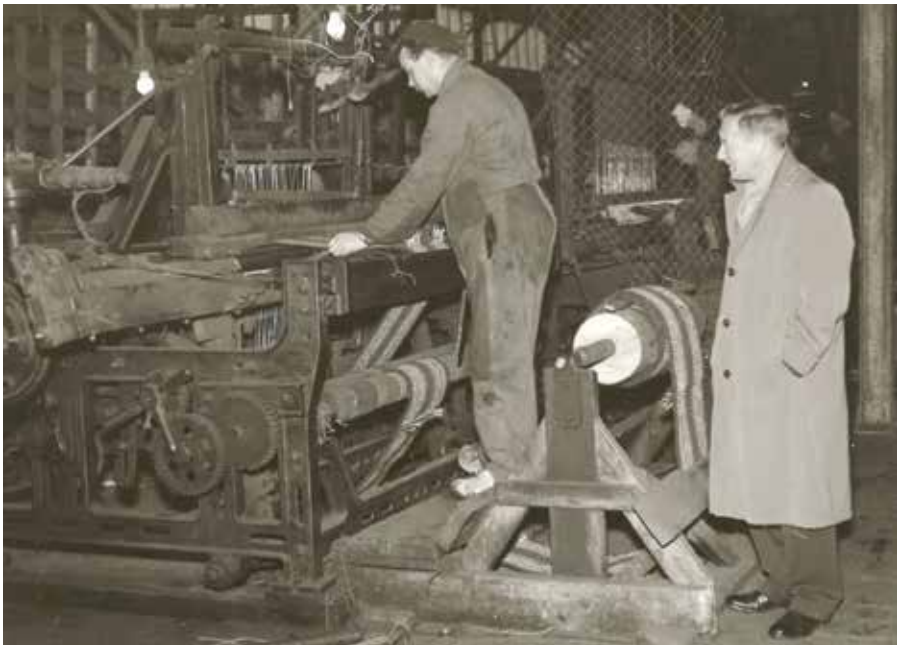
Jaren vijftig. De heer A. Hoekman laat aan een inkoper zien hoe lange smalle banen voor kleine deurmatjes geweven worden. De banen werden in stukken geknipt en met de hand omgezoomd. De weefmachine is nu te zien in het Tapijtmuseum Genemuiden. Een filmpje illustreert de werking ervan. Foto privécollectie.
